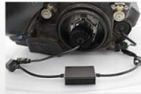
⑥LED本体の遮光板(傘)が 下部へくるように差し込み、 時計回りに回し、台座に 固定します
