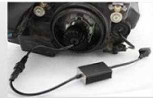
⑧車両からのコネクターを付けて 取付け終了です
