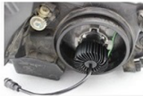
⑥LED本体の遮光板(傘)が 下部へくるように差し込み、 時計回りに回し、台座に 固定します
